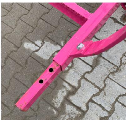
03 Die Verschraubung der Zwischenstücke erfolgt mit jeweils 4 Schrauben M12 (SW19, Festigkeit min. 8.8) mit selbstsichernden Muttern.
