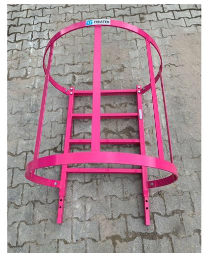
02 Über ein Schraubensystem kann die Länge der Verbauleiter variiert werden. 1,00 m lange Zwischenstücke (Eigengewicht: 39 kg) verlängern die Verbauleiter bis max. 10,00 m.
